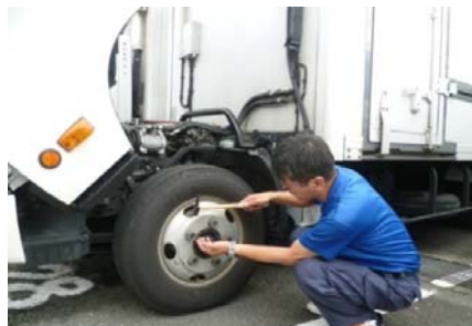
整備管理者によるホイールナットの締め付け点検指導の様子
